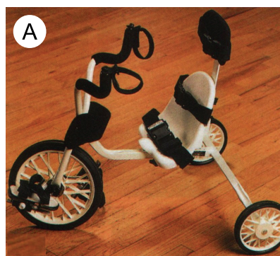
手柄经过改造的特殊三轮车,配有头部支撑架和身体约束带。
